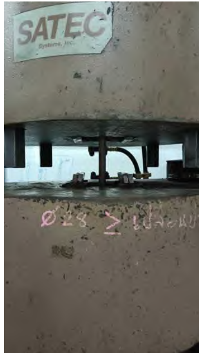
รูปที่ 6-9 การจัดตำแหน่งความยาวพิกัดของเหล็กเสริมกึ่งกลางอุปกรณ์ยึดจับ
