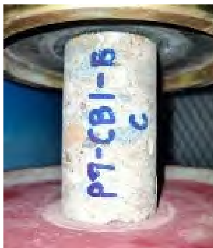
รูปที่ 6-4 เครื่องมือทดสอบกำลังรับแรงอัดของคอนกรีต
