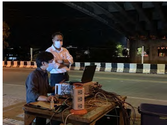
รูปที่ 7-16 ภาพการทดสอบแบบสถิต (Span 1&2)
