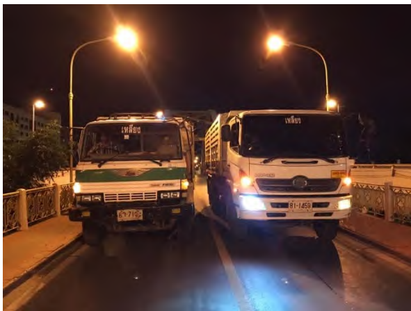
รูปที่ 7-54 ตัวอย่างภาพการทดสอบแบบสถิต (Span 6)
