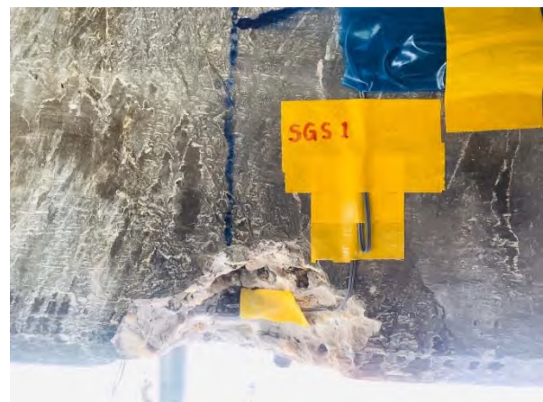
รูปที่ 7-44 ตัวอย่างภาพการติดตั้งอุปกรณ์ตรวจวัดสะพาน (Span 5)
