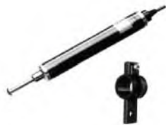
(ค) อุปกรณ์วัดการเคลื่อนที่ (Displacement Transducer)
