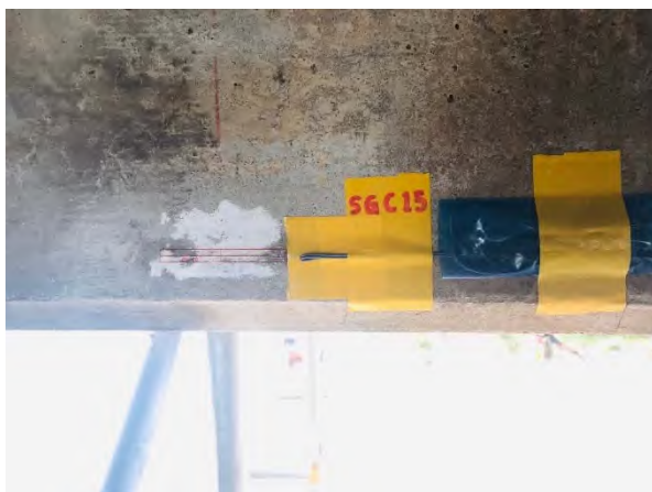
รูปที่ 7-25 ตัวอย่างภาพการติดตั้งอุปกรณ์ตรวจวัดสะพาน (Span 3)
