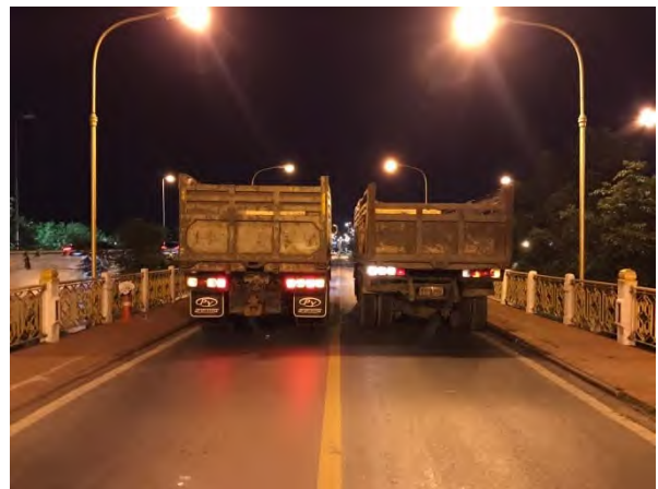
รูปที่ 7-54 ตัวอย่างภาพการทดสอบแบบสถิต (Span 6)
