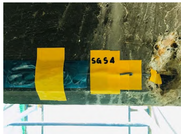
รูปที่ 7-14 ตัวอย่างภาพการติดตั้งอุปกรณ์ตรวจวัด (Span 1&2)
