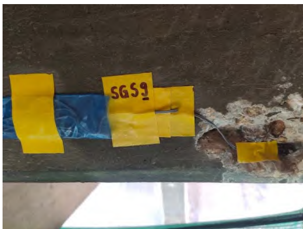
รูปที่ 7-14 ตัวอย่างภาพการติดตั้งอุปกรณ์ตรวจวัด (Span 1&2)
