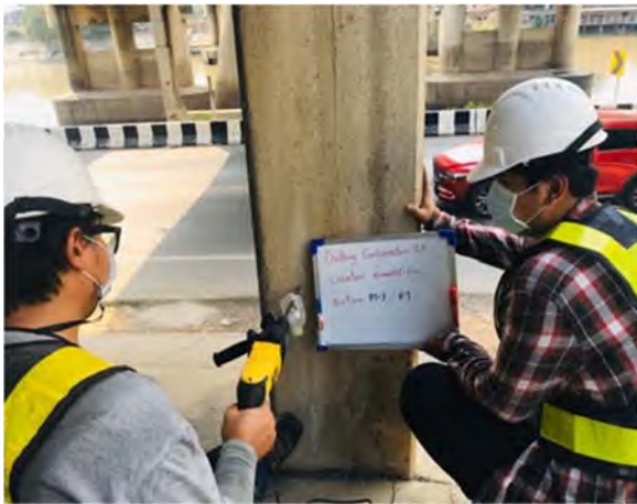
(ก) การเจาะเก็บผงตัวอย่างคอนกรีต
