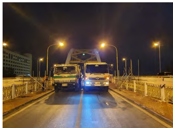
รูปที่ 7-45 ตัวอย่างภาพการทดสอบแบบสถิต (Span 5)
