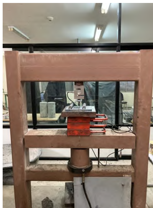
รูปที่ 6-6 เครื่องมือทดสอบกำลังรับแรงดึงแบบผ่าซีก (Splitting tensile test)
