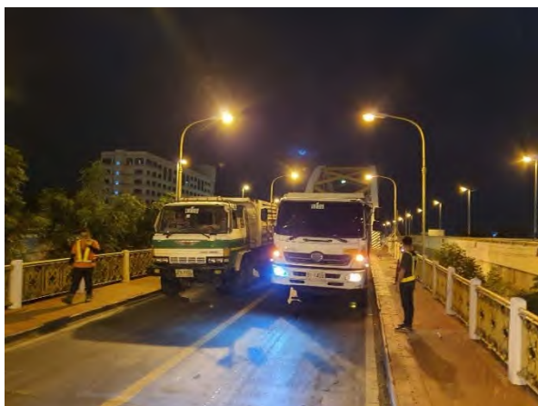
รูปที่ 7-45 ตัวอย่างภาพการทดสอบแบบสถิต (Span 5)
