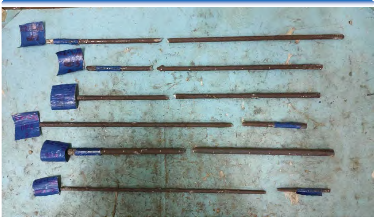
รูปที่ 6-10 ชิ้นตัวอย่างเหล็กเสริมหลังการทดสอบ
