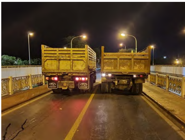
รูปที่ 7-63 ตัวอย่างภาพการทดสอบแบบสถิต (Span 7&8)
