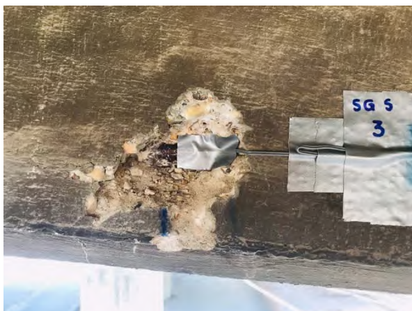
รูปที่ 7-62 ตัวอย่างภาพการติดตั้งอุปกรณ์ตรวจวัดสะพาน (Span 7&8)
