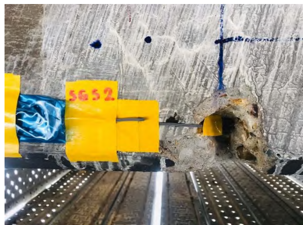
รูปที่ 7-25 ตัวอย่างภาพการติดตั้งอุปกรณ์ตรวจวัดสะพาน (Span 3)
