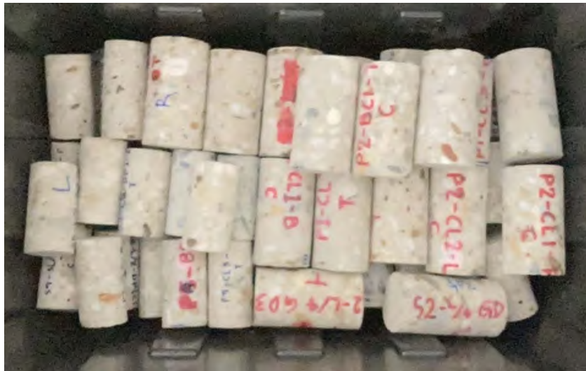
รูปที่ 6-3 แท่งตัวอย่างคอนกรีตหลังจากการ Core Drilling
