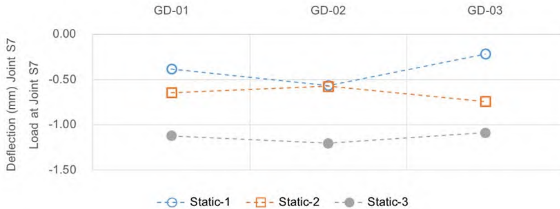
รูปที่ 7-67 การแอนตัวที่ปลายคานยื่น (Span 7)
