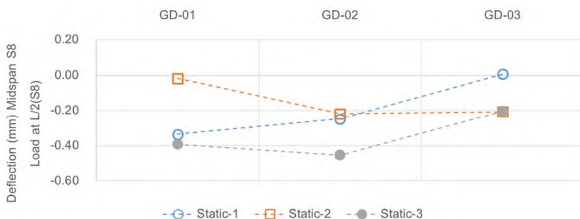
รูปที่ 7-69 การแอนตัวที่กึ่งกลางช่วงสะพาน (Span 8)
