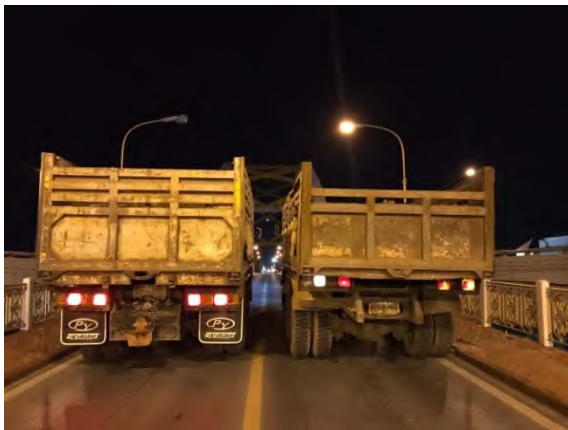
รูปที่ 7-16 ภาพการทดสอบแบบสถิต (Span 1&2)
