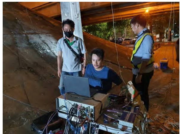
รูปที่ 7-63 ตัวอย่างภาพการทดสอบแบบสถิต (Span 7&8)
